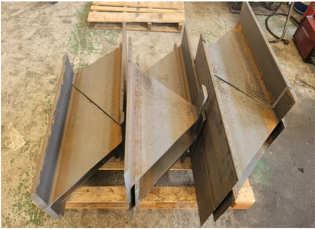
브라켓 공장 제작
